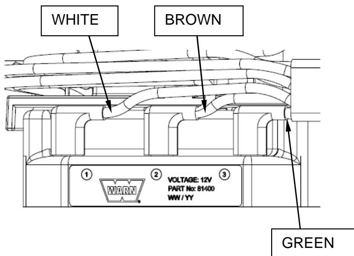
INSTALL HARNESS FLAG TERMINAL TO CONTACTOR TERMINALS AS SHOWN.
